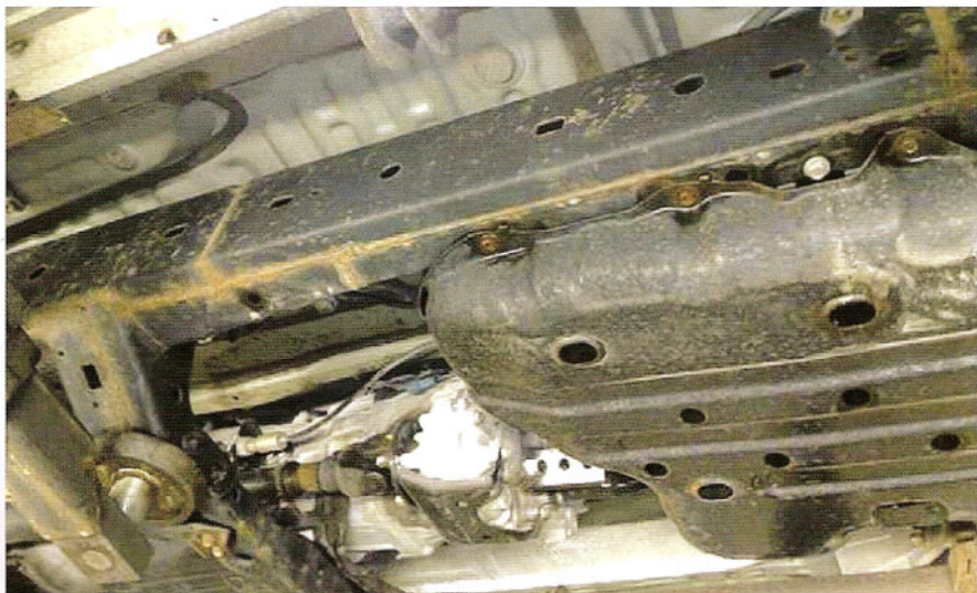
Nesten nye biler er sterkt angrepet av rust. Dette kunne ha vært unngått om bileier eller bilforhandler hadde vært forutseende og latt et antirustverksted behandle bilen den gang den var ny i Norge
