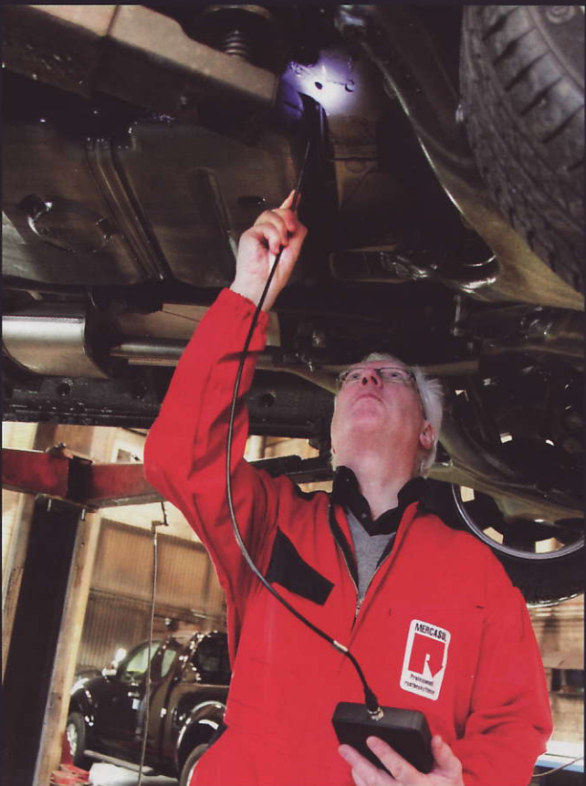
Enger & Hedlund følger opp kvaliteten på behandlingen med endoskopiske undersøkelser på uanmeldte besøk. Her er det Staffan Hedlund som foretar kontrollen.
