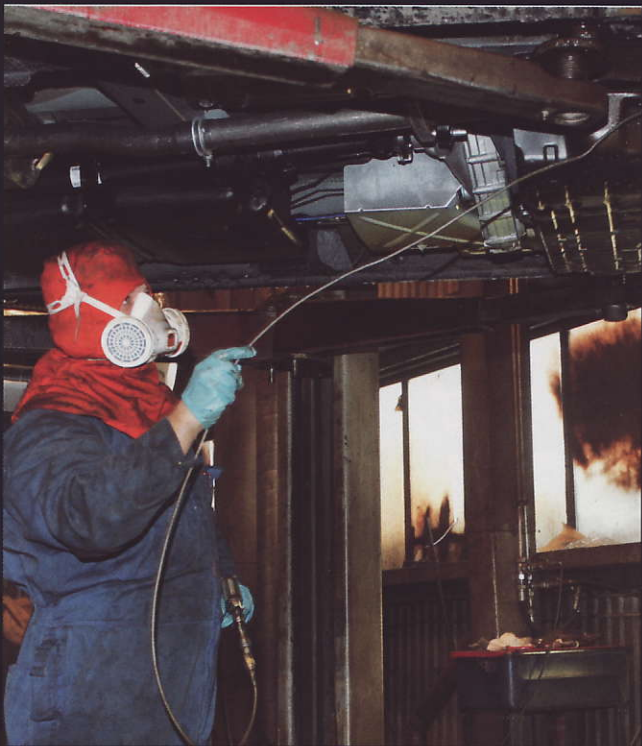
Lange sprøyteslanger tres inn i kanaler og hulrom og trekkes ut mens sprøytingen foregår.
