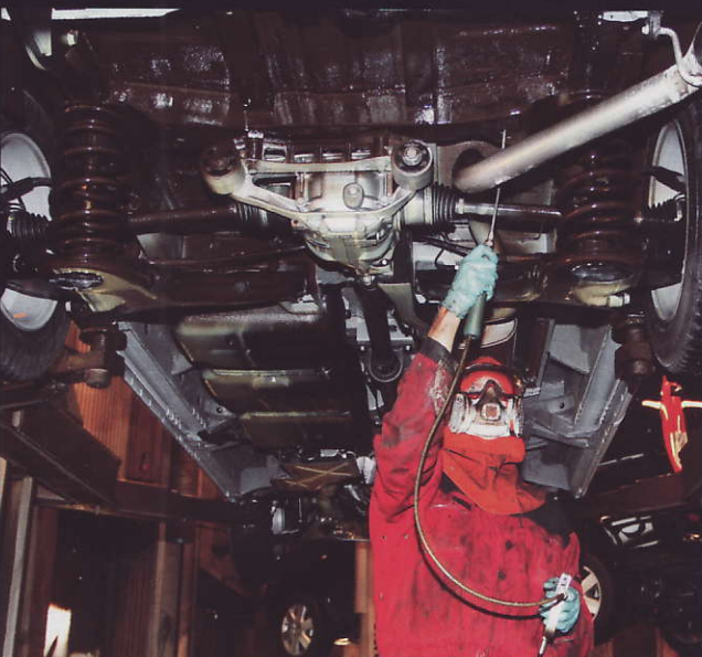
Operatøren har krav på seg om å sprøyte hver vil nøye. Ca en time brukes på hver bil.
